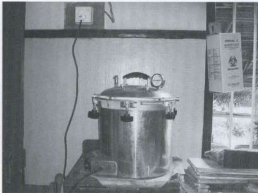
医療器具を滅菌する装置。 患者さんへの処置も清潔に行われるようになった。
