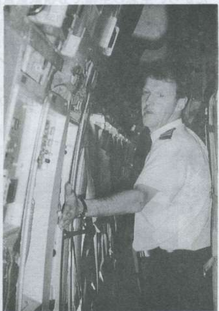
カーゴハッチのスイッチと電源を説明中。 凍結ワクチンも運べる。 最後尾の圧力隔壁(左)部には貨物を置かない。 その脇にはボイスレコーダとフライトレコーダ が見える。
